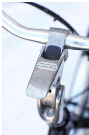
Pressione o botão preto no avanço e levante a palanca para o ajuste do guidador. A altura do guidador pode ser ajustada usando uma chave Allen.
