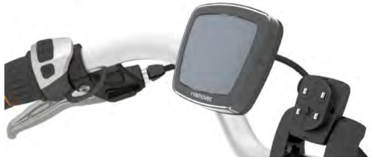
Depois de inserir a tela, ligue a bateria. Se o LCD não está montado na EBI-KE, a bicicleta funcionaria como uma bicicleta convencional.
