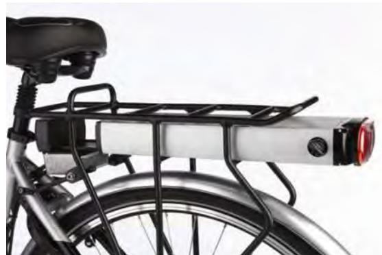
Gire a chave de ignição da bateria para abrir a fechadura e retire a bateria. Montar a bateria no suporte prateleira. Em seguida, ligue a chave de ignição para bloquear a bateria.
