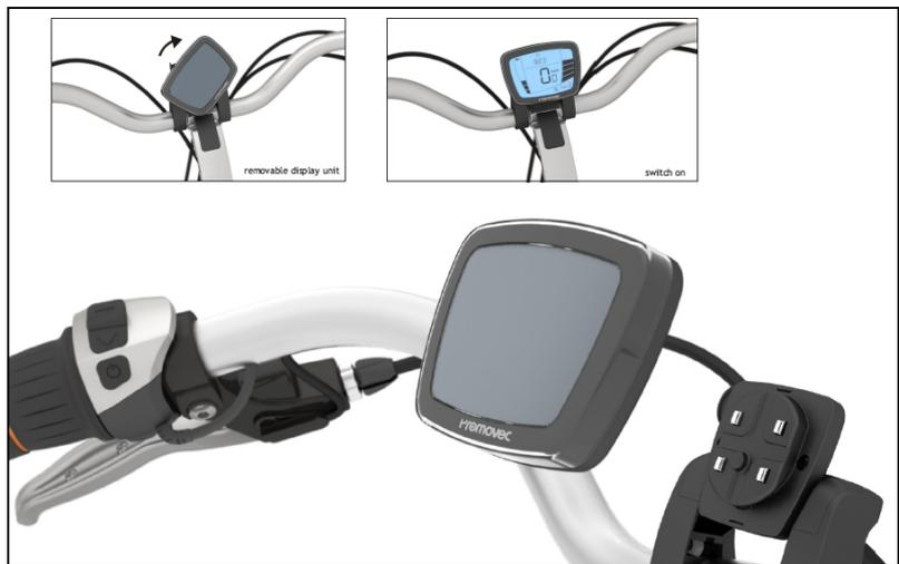
Lorsque l'écran est inséré, il active le système électrique. En d'autres termes, l'écran LCD fonctionne aussi comme une clé pour le système électrique. Après avoir inséré l'écran, mettez la batterie en marche. Si l'écran LCD n'est pas monté sur l'e-bike, l'e-vélo fonctionnera comme un vélo conventionnel.
