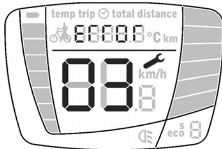
Le code d'erreur apparaîtra dans la "indication de la vitesse" l'espace dans le centre de l'écran. Les numéros de code d'erreur varie de 01 à 13 indiquant les différents types d'erreurs.
