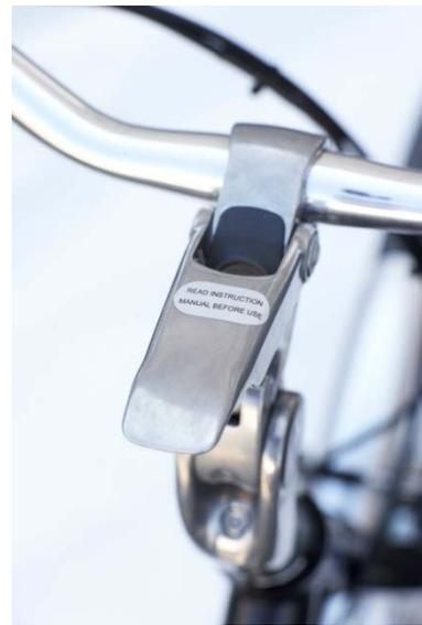
Appuyez le bouton noir situé sur la potence pour régler l'ajustement du cintre. La hauteur du cintre peut être réglée à l'aide d'une clef Allen.
