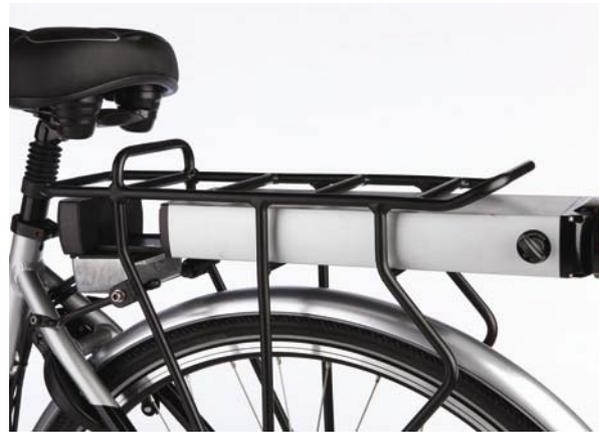
Tournez la clef de contact de la batterie pour ouvrir la serrure et sortir la batterie. Montez la batterie sur le rack et rentrez-la au maximum. Ensuite tournez la clef de contact pour bloquer la batterie.
