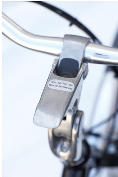
Empuje hacia arriba el botón negro y levante la maneta para poder ajustar el manillar en la posición deseada.
