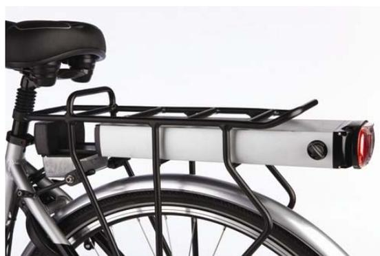
Gire la llave de la batería (ON/OFF) posición abierta y sacar la batería del porta equipajes
