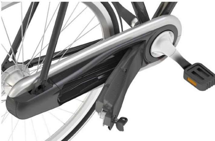
La batería está integrada dentro del cubrecadenas .
