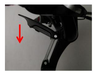
7. Vérifier si le guidon et la tige sont ajustés correctement. Sinon, serrer les vis de fixation avec les clés hexagonales 2 mm.
