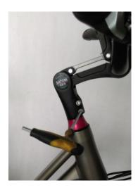
2. Serrer la vis de réglage Avec les clés hexagonales 2 mm.
